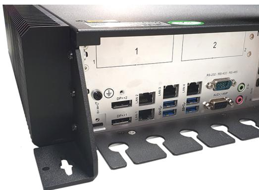
*Fixez les deux supports de montage de chaque côté du panneau arrière. Monter la plaque de maintien du câble.*
